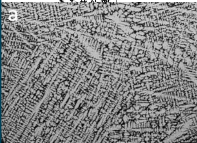
(a) Cu-Ni (30%) 合金铸态组织 (100X); (b) Cu-Ni (30%) 合金扩散退火组织 (100X)
