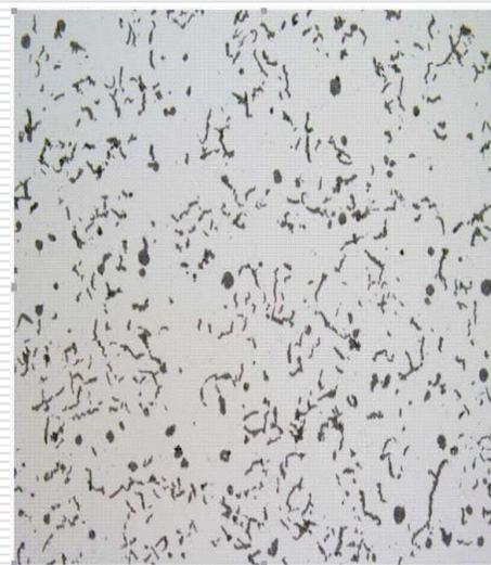
蠕墨铸铁光学显微组织照片
