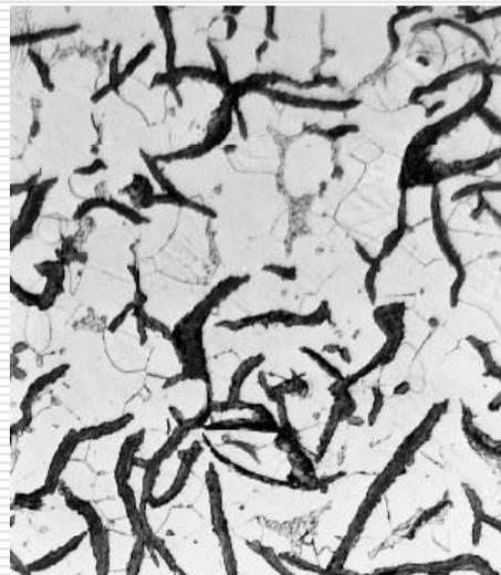
灰铸铁光学显微组织照片
